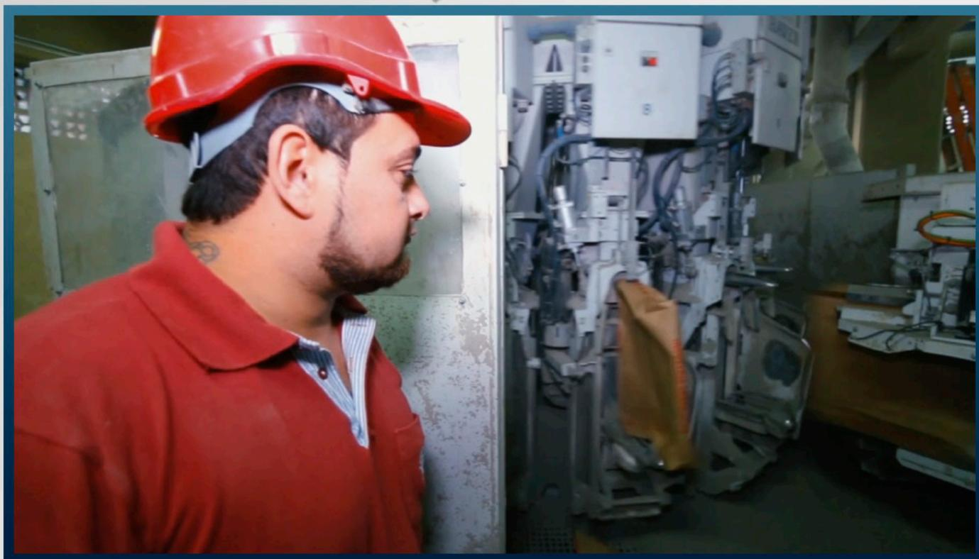
El cemento es transportado desde los silos por medio de una bomba neumática hasta el sistema de embolsado. Este sistema cuenta con un aplicador de bolsas automático, el cual por succión inserta las bolsas vacías al pico de boca de carga de la embolsadora.
