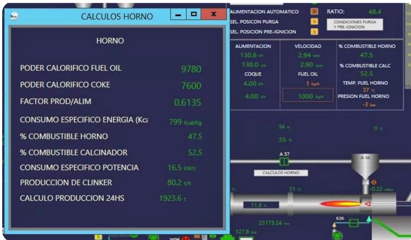
Luego del excelente trabajo ejecutado entre técnicos de ambos frentes fabriles, el Horno de Vallemi recupera el nivel de producción para seguir en ascenso. Actualmente produce **1.900ton/día con una calidad superior de 65% de Silicato tricálcico C3S**, siendo este el valor más alto registrado en el año. El Silicato tricálcico permite producir un cemento de alta resistencia inicial, por su mayor velocidad de hidratación para el fraguado.
