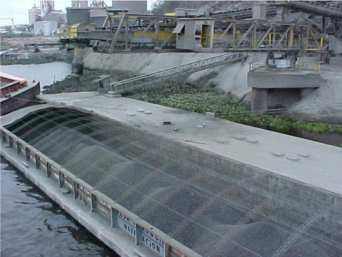
Barcaza con sistema inapropiado para la carga de Clinker
